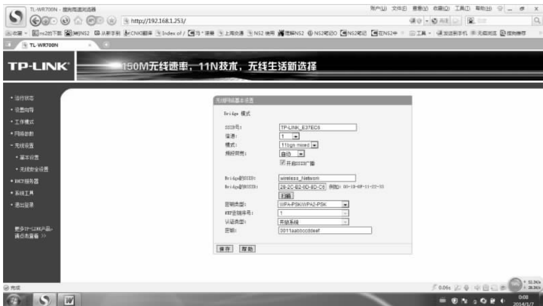
图 1-30 桥接模式设置完成
