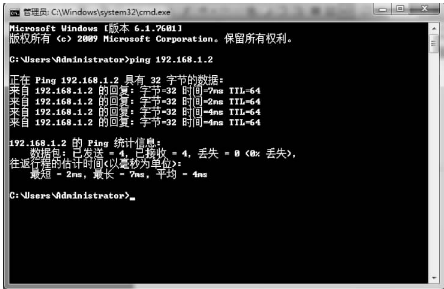
图 1-32 连通性测试结果
