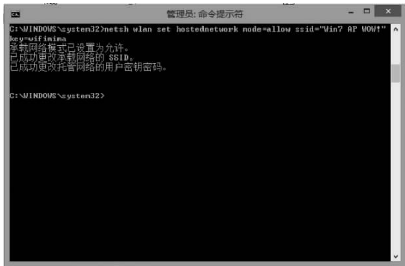
图 1-38 启用虚拟无线网卡
