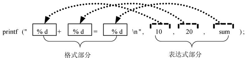
图 1.2 printf 函数输出示例图
