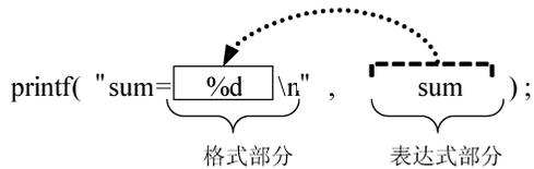
图 1.1 printf 函数输出示例图
