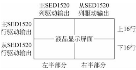
图 3-4 液晶显示器件驱动结构示意图
