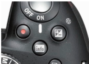
图 3-4 尼康 D5200 设置光圈功能集成在曝光补偿按钮内
