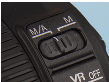
图 3-5 尼康 AF-S DX 18~200mm 镜头上的对焦选择开关
