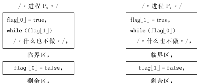
图 3-7 双标志、先修改后检查算法
