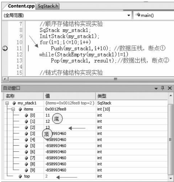
图 4-1 顺序栈入栈相关数据变化调试监视信息
