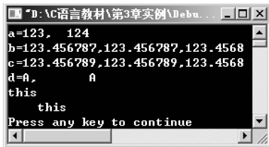
图 3-17 printf() 函数输出格式
