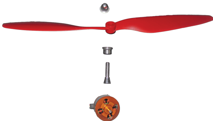
图 5.4 螺旋桨安装分解图
