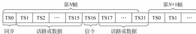
图 3.3 32/30 路 PCM 系统时隙分配
