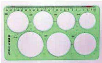
图2-13 此为汽车设计师使用较多的圆模板，此外还有椭圆模板，可以帮助汽车设计师画出各视角度的车轮
