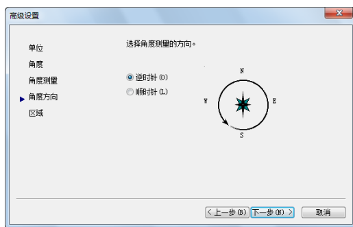
图 1-27 设置角度测量的方向
