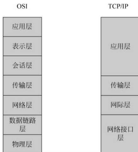
图 3.8 OSI 参考模型与 TCP/IP 参考模型对比
