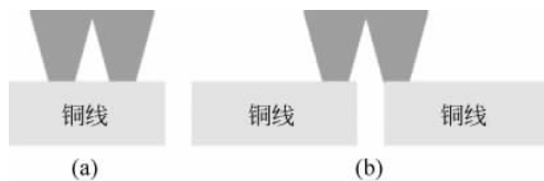
图 5.1 通孔短路的不同情况
