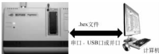
图 1-4 编程器烧写目标程序
