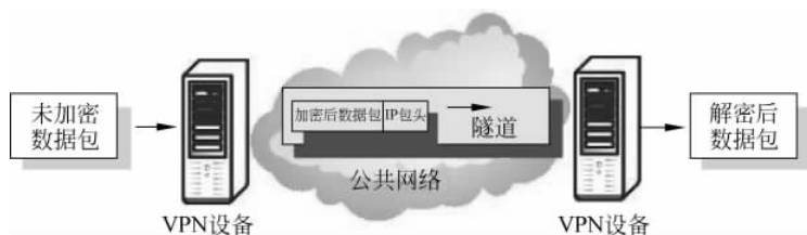
图 3.2 虚拟专用网络(VPN)基本原理
