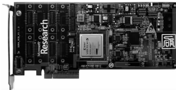
图 3-2 Sora 无线控制板(RCB),可以通过 PCIe 接口与个人计算机(PC)相连
