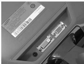
图 3-13 带有 VGA 和 DVI 双接口的显示器
