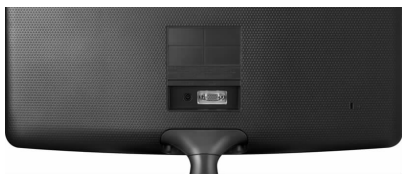
图 3-12 只带有 VGA 接口的显示器
