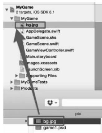
图 5-8 拖曳图片进入 Xcode 程序中
