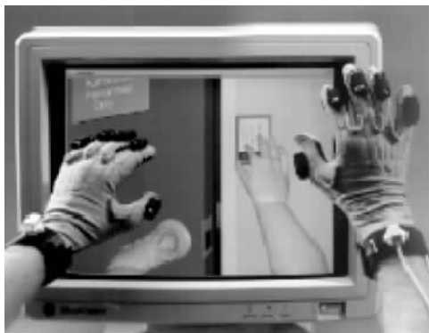
图 3-37 Virtual Technology 公司的 触觉反馈手套
