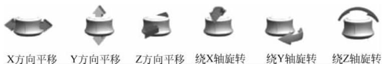
图 3-19 3D 鼠标的轨迹球控制方式
