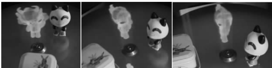
图 3-54 可深入光场三维显示(图中的福娃为显示的三维影像,其他为真实物体)
