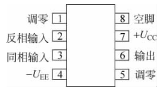
图 5.2 \mu A741 引脚图
