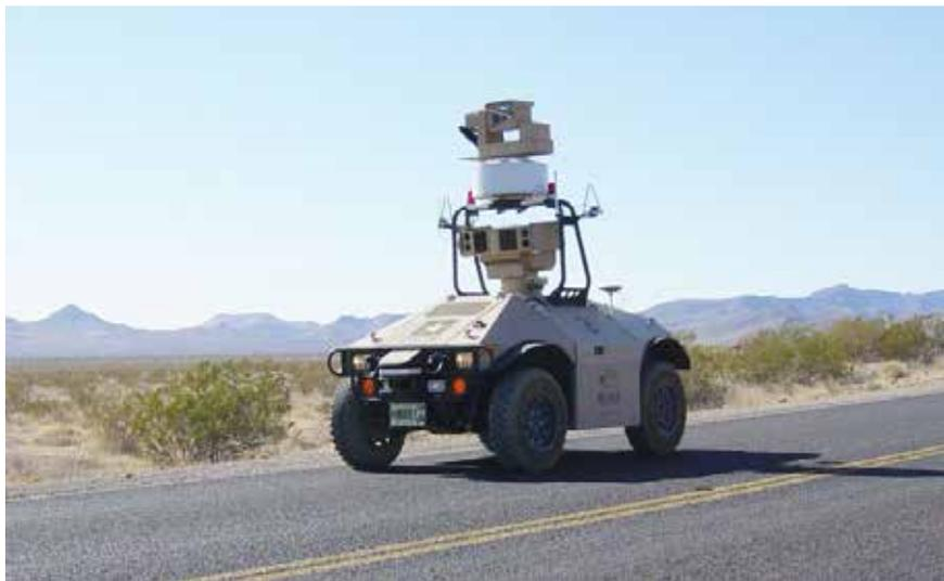
机动探测评估响应系统（Mobile Detection Assessment and Response System, MDARS）是美国陆军装备的一种能够在室外环境中执行半自主随机巡逻和监视任务的无人车。
