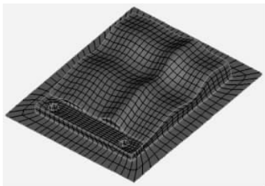
图 1-5 编辑处理后的四边曲面片
