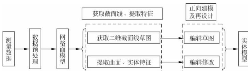
图 1-3 Geomagic Design Direct 混合建模流程
