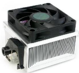
图 3-32 CPU 风冷散热器
