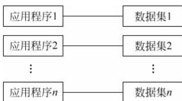
图 3.20 人工管理方式的数据与程序的关系
