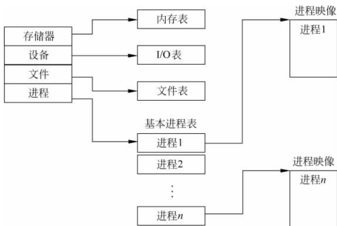
图 3.16 操作系统控制表的通用结构
