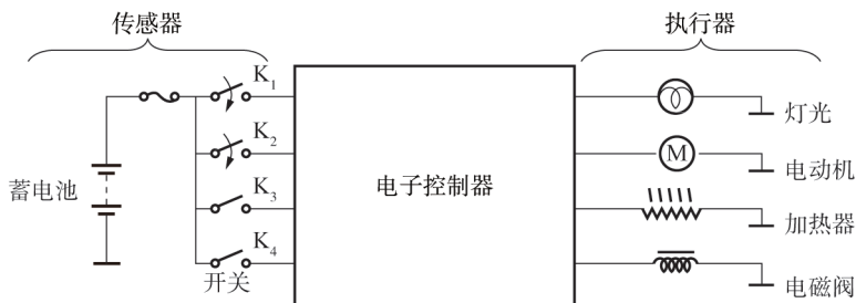
图1-2 汽车电控系统的结构模型
