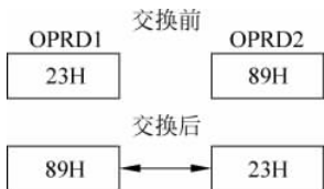
图 3.9 XCHG 指令操作示意图
