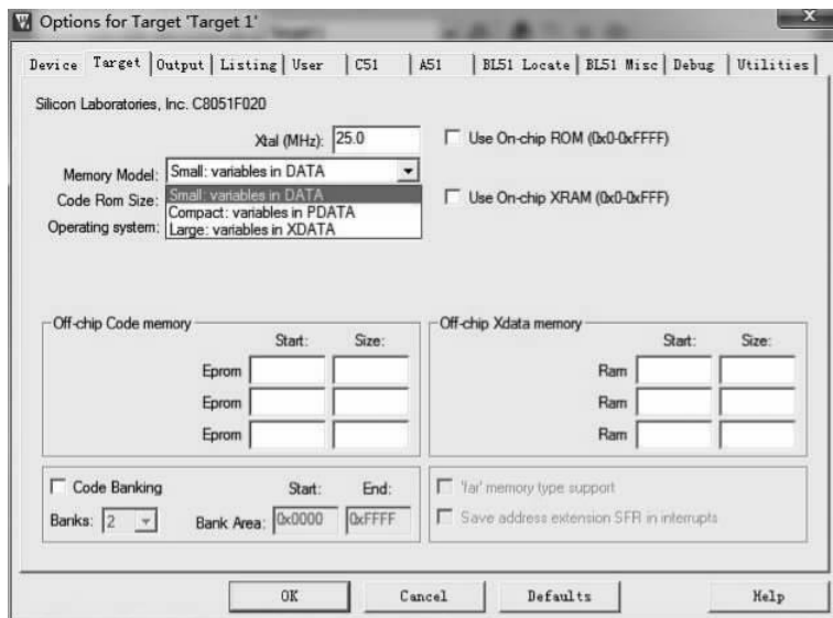
图 3-7 在 IDE 中设置存储模式
