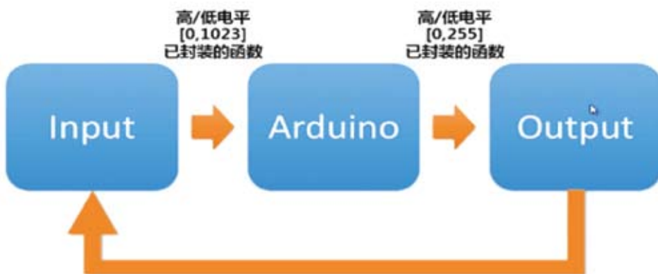
图0-8 Arduino和传感器之间进行通信
