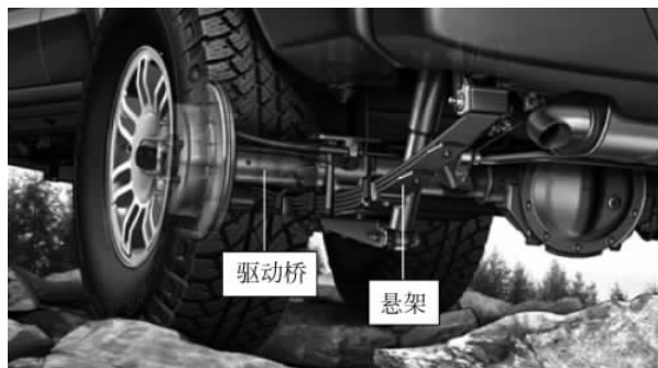
图 3-9 汽车驱动桥与悬架的连接关系
