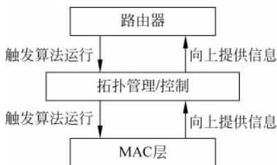
图 3-7 拓扑控制与网络分层关系示意图
