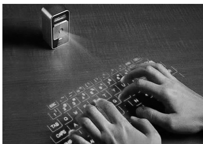
(a) 正在操作的虚拟激光键盘
