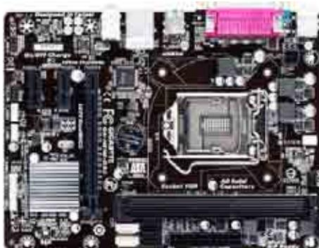
● CPU：CPU是电脑解释和执行指令的部件，它控制整个电脑系统的操作，因此CPU也被称作电脑的“心脏”。CPU安装在电脑主板的CPU插座中。CPU由运算器、控制器、寄存器及实现它们之间数据联系、控制的总线构成。其运作原理大致可分为提取(Fetch)、解码(Decode)、执行(Execute)和写回(Writeback)4个阶段。
