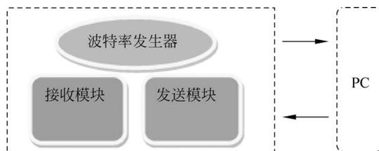
图 1-3 串口通信的功能模块
