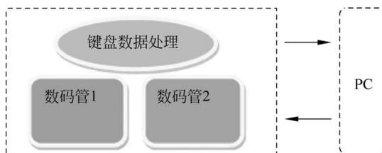
图 2-3 PS/2 键盘接口设计模块
