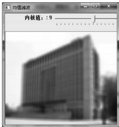
图 3-34 内核为 10 \times 10 的均值滤波结果
