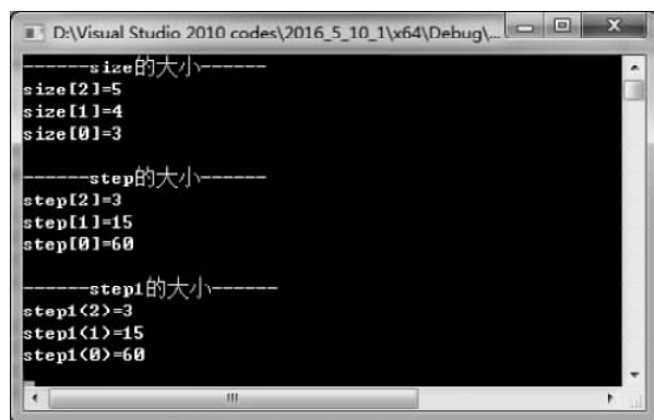
图 3-4 Mat 中 size、step 和 step1 的区别
