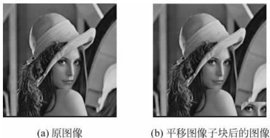
图 3.7 图像(图像子块)平移示例
