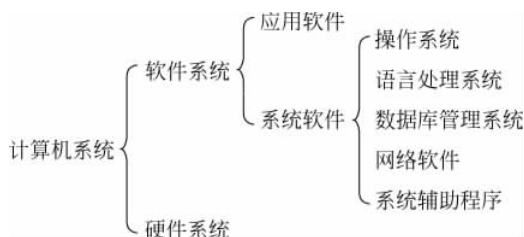
图 3.1 计算机系统组成简单示意图
