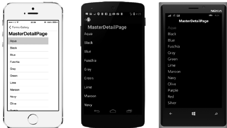
图 3.4 Xamarin Master Detail 视图在 iOS、Android、Windows Phone 三个平台上的展现
