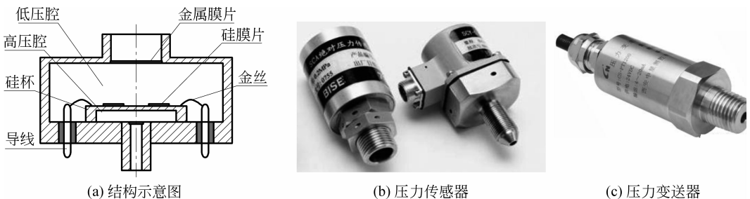
图5-7 扩散硅压力传感器结构实物
