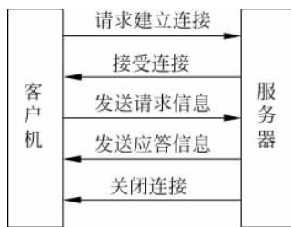
图 3.14 HTTP 完成一次 WWW 服务的过程
