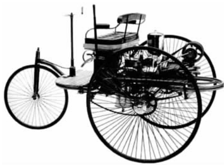
图 1-14 1886 年本茨制造的装有汽油机的三轮汽车
