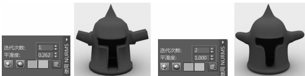
图 3-16 “迭代次数”和“平滑度”参数值对平滑效果的影响
