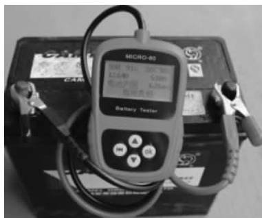
图 3-17 蓄电池检测仪
