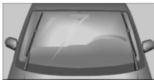
图 3-8 前挡风玻璃上出现条纹状的刮拭痕迹
