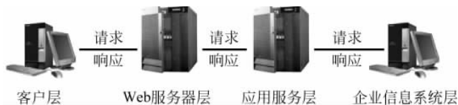
图 3-5 电子商务系统多层结构示意图
