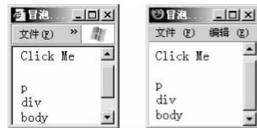
图 3-16 IE 和 Firefox 浏览器均采用冒泡型事件
