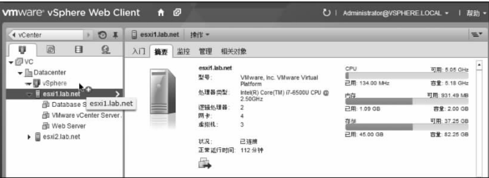
图 5-44 拖动 ESXi 主机到群集中
