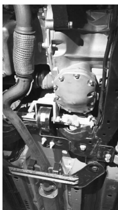
图 3-1-6 安装壳体盖螺栓
