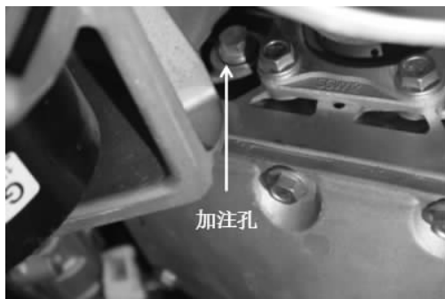
图 3-1-2 变速箱油加注孔位置
