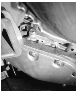
图 3-1-3 拆卸加油口塞
