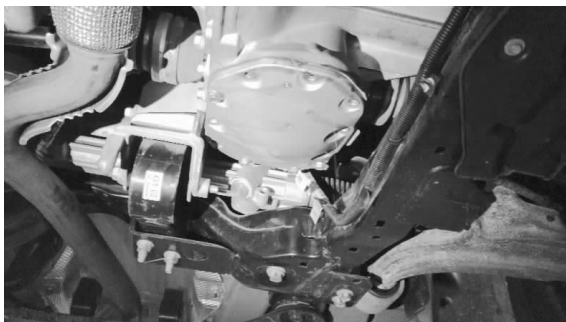
图 3-1-5 拆下壳体盖螺栓
