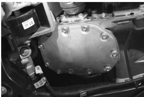
图 3-1-1 渗漏情况的检查
