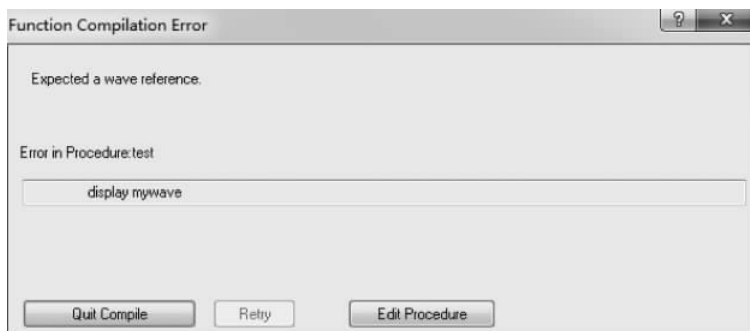
图 5-26 rtGlobals=3, wave 必须声明引用后才能使用
