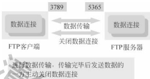
图 23-9 FTP 被动方式阶段四
