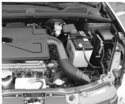
图 3-3 蓄电池安装在发动机箱内
